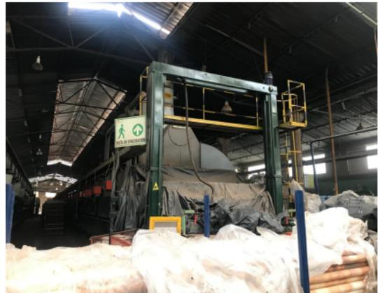
**Fotografía 10.** Secador (Horno Rodillo Usme 4)
