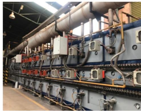
**Fotografía 6.** Horno Rodillo Usme 4 que opera con gas natural como combustible
